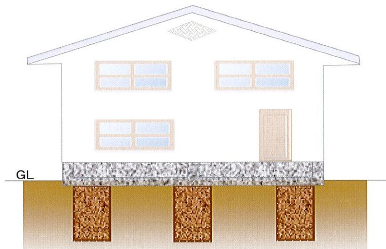
\* SWS調査データと資料調査・現地ロケーションによる地盤解析をし、支持力と沈下の検討を総合的に行ない、MS工法のタイプを選定します。
